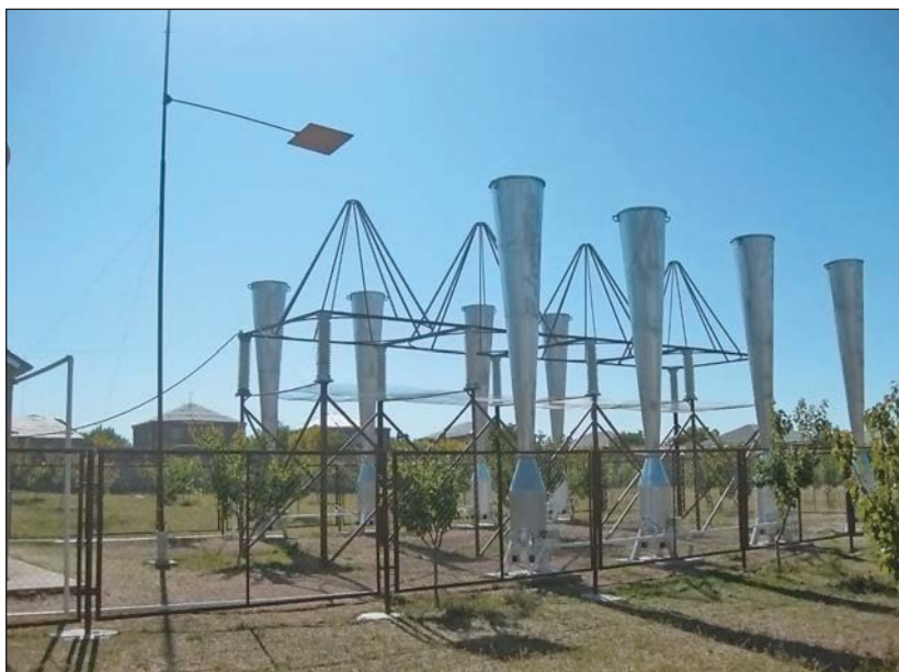
Комплексная установка «RAINSTIM», состоящая из восьми противорадовых установок и четырех инжекторов заряженных частиц.
